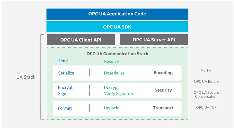
Figure 6 - OPC UA Communication Stack
