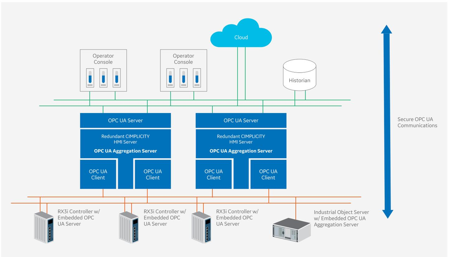
Figure 17 - OPC UA System Architecture
