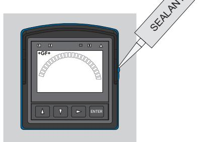
Optional: Für eine wassererdichte Versiegelung (NEMA 4X, IP66 oder höher) muss die Sonnenblende rundum mit Dichtmittel abgedichtet werden.
