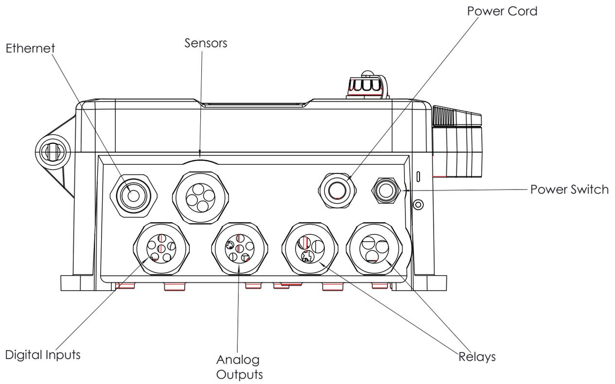
**Figure 5 Conduit Wiring**
