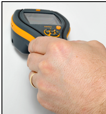
Figura 2: Uso del medidor de humedad con clavijas
