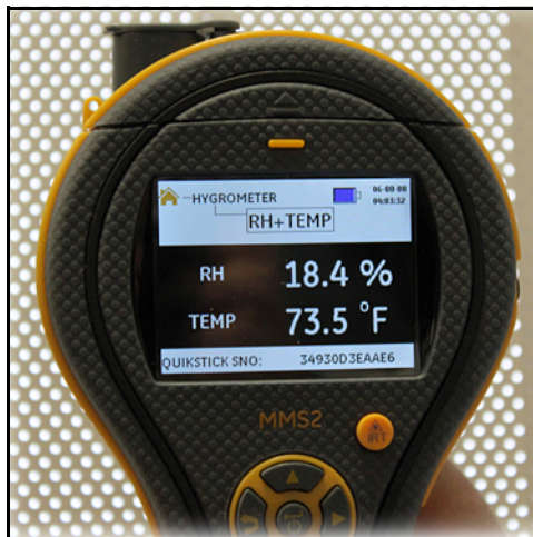
Figura 4: MMS2 como higrómetro
