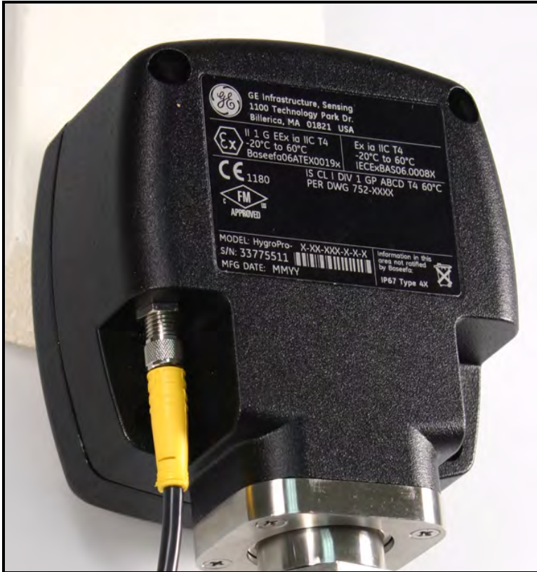
Figura 9: Etiqueta de certificación de HygroPro – Vista posterior
