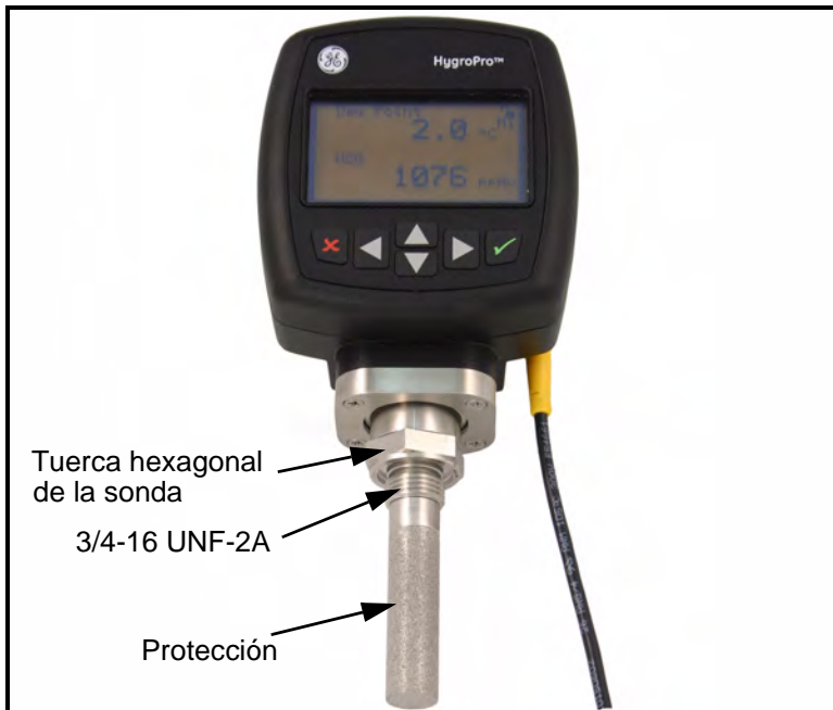
Figura 2: Instalación de HygroPro
