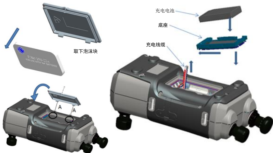
图 2 安装充电电池套件
