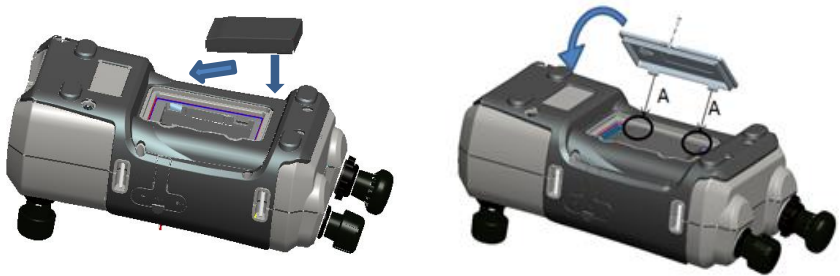
Figura 3 - Instalarea bateriei reîncărcabile
