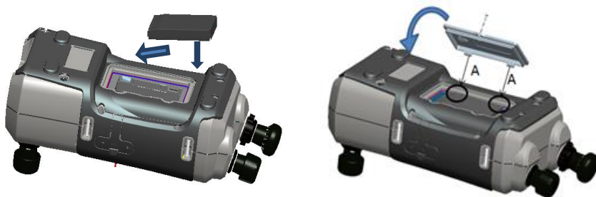
Figur 3 Monter oppladbart batteri
