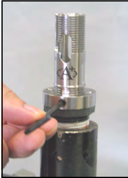
Figura 13: Alineación y ajuste de los tornillos Allen
