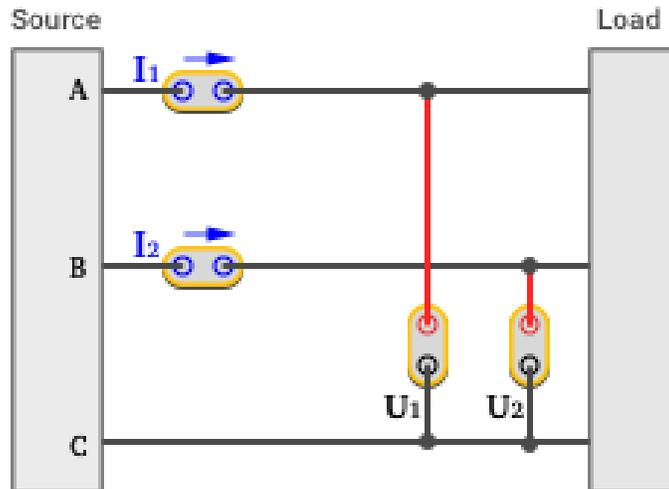
**Figure 11. 3P3W2M wiring**
