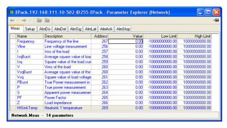
Figure 140 Typical parameter table
