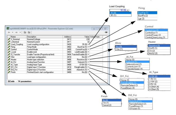
Figure 119 Quick code parameters
