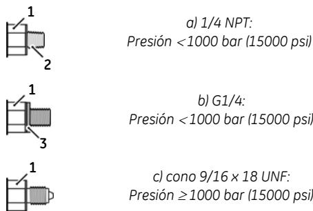
**Figura 1:** Métodos de conexión
